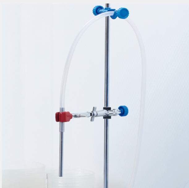
3. Positionner les pinces à la hauteur souhaitée sur le support vertical, en s'assurant que la partie métallique du tube est fixée à la pince inférieure.
