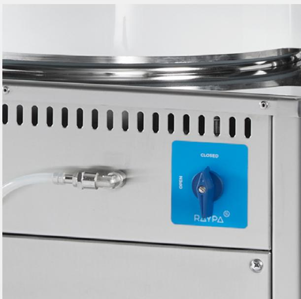
1. Raccorder l'extrémité libre du tuyau de distribution à l'orifice de distribution du préparateur de milieux.
