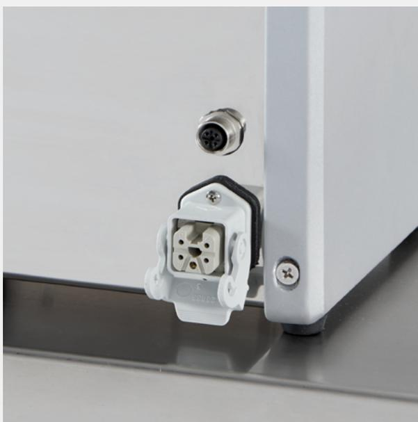
4. Selon le système de distribution utilisé, raccorder le capteur optique ou la pédale à la station de dosage externe.
