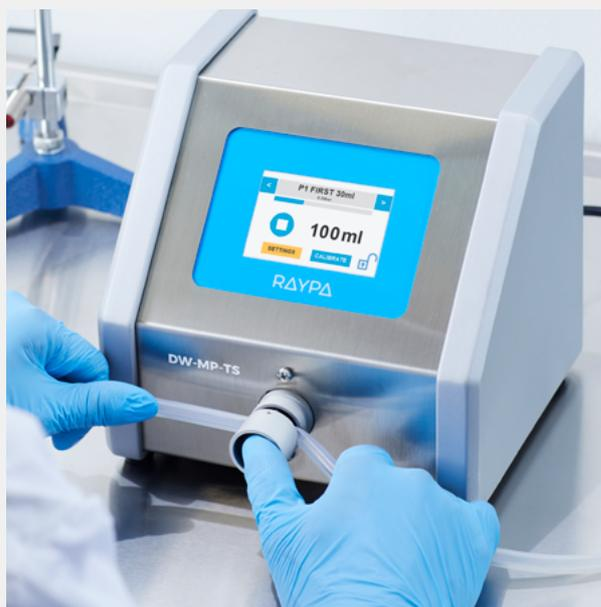
2. Insérer le tuyau de distribution dans l'électrovanne à pincement de la station de dosage externe.
