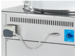
**2.** Colocar el selector de dosificación en modo "OPEN" y verificar que la línea de dosificación esté pinzada por la bomba peristáltica.
