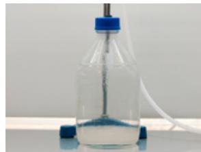
**3.** Colocar la boquilla metálica de la línea de dispensación en el interior del frasco suministrado.
