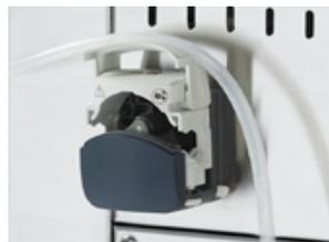
**2.** Revisar que la línea de dispensación no esté pinzada por la bomba peristáltica o la estación de dosificación externa.
