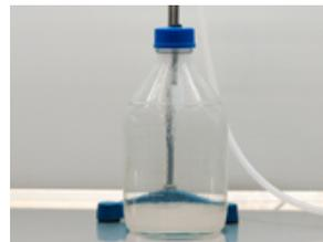
**3.** Placer la buse métallique du tuyau de distribution à l'intérieur de la bouteille fournie.
