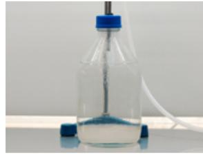
**3.** Placer la buse métallique du tuyau de distribution à l'intérieur de la bouteille fournie.
