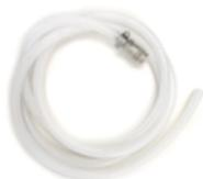
2 tuyaux de silicone renforcée de 2 m et de Ø 9x16 mm avec un raccord rapide au préparateur de milieux et un raccord libre au système d'évacuation à l'autre extrémité.
