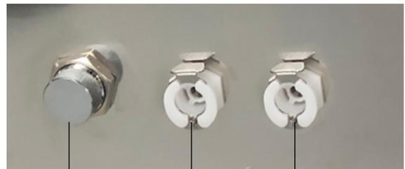
**4.** ACCESO AL FILTRO DE DESAGÜE Y SALIDA DRENAJE DE LA CÁMARA DE ESTERILIZACIÓN
