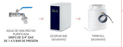
B. Utilizar un tanque de agua purificada del cliente que se conectará a la entrada de alimentación automática de agua de la autoclave.
