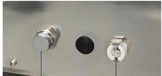
**4.** ACCÈS AU FILTRE D'ÉVACUATION ET À LA SORTIE DE VIDANGE DE LA CHAMBRE DE STÉRILISATION
