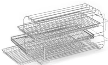
1 châssis en acier inoxydable de 200 x 400 x 180 mm d'une capacité de 4 bacs. Comprend 3 bacs en tiges d'acier inoxydable de 190 x 350 mm. Châssis spécial compatible contenant jusqu'à 5 bacs disponibles sur demande.
