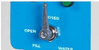
La vanne (3) doit être en position «FERMÉE» lors du remplissage du réservoir d'eau indépendant et pendant le fonctionnement normal de l'autoclave.
