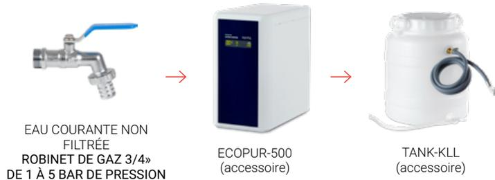
**B.** Utiliser un réservoir d'eau purifiée qui sera raccordé à l'arrivée de l'alimentation en eau automatique de l'autoclave.
