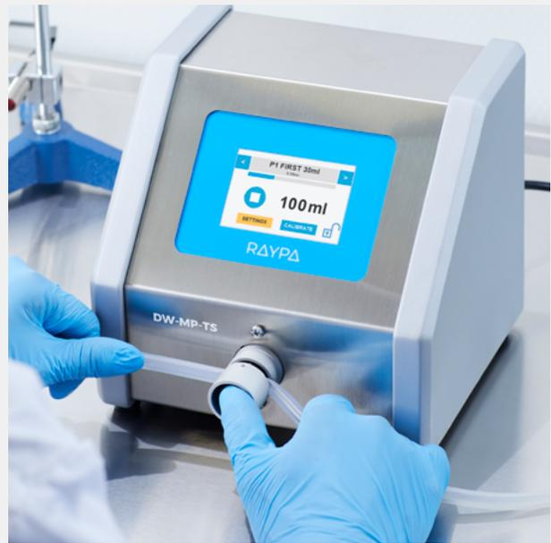
2. Colocar la línea de dispensación dentro de la electroválvula de pinza de la estación de dosificación externa.
