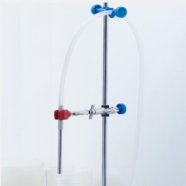
3. Colocar las abrazaderas en el soporte a la altura deseada, con la parte metálica de la línea sujeta por la abrazadera inferior.
