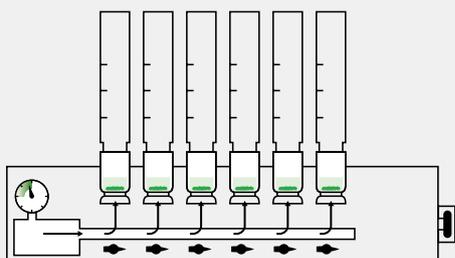
Durante la filtración puede ser necesario romper los grumos compactos utilizando la bomba de aire integrada.
